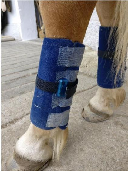
*Abbildung 5: Anbringung des Mini-Datenloggers MSR145 an der Pferdextremität*
