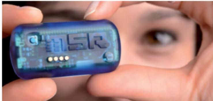
Der kompakte Universal-Datenlogger MSR145 ist in der Lage, die fünf wichtigsten physikalischen Messgrößen Temperatur, Feuchte, Luftdruck, Lage/3-Achsen-Beschleunigung und Licht über einen langen Zeitraum hinweg zeitgleich zu messen und zu speichern.
