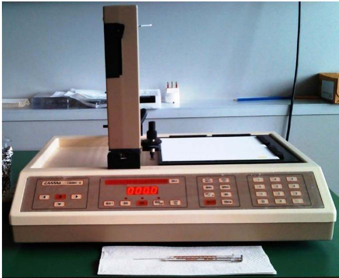
*Abb. 11: automatisches Auftragegerät Camag Linomat IV*
